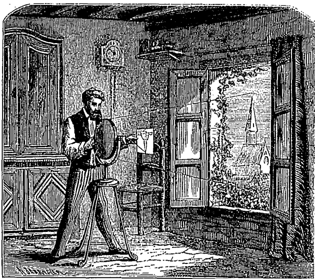
Fig. 23. — Renversment des images par le miroir concave.
